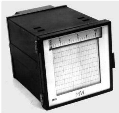
Предназначены для измерения и непрерывной записи активной и реактивной мощности в трехфазных сетях переменного тока 50 или 60 Гц без нулевого провода с неравномерной нагрузкой фаз. В приборе используется измерительный преобразователь мощности с модуляцией входных сигналов.
