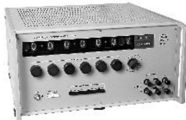
Калибратор П 320 с ручным и программным управлением предназначен для применения в автоматизированных поверочных установках, а также, как самостоятельный прибор для проверки аналоговых и цифровых приборов на постоянном токе.
