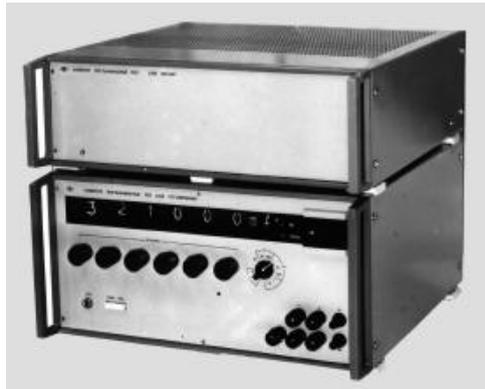
Калибратор П 321 с ручным и программным управлением применяется в автоматизированных поверочных установках, а также как самостоятельный прибор для проверки аналоговых и цифровых приборов постоянного тока.
