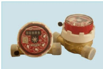
Предназначен для измерения объема питьевой воды по ГОСТ 2874 - 82 в системах холодного и горячего водоснабжения при давлении не более 1,0 МПа (10кгс/см<sup>2</sup>). Водомеры типа СКВ работают в диапазоне температур измеряемой среды от 5 до 90 оС.
