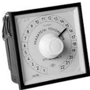
Предназначен для указания положения переключающего устройства трансформаторов с регуляторами напряжения под нагрузкой и работает в индикаторном режиме в паре с сельсин - датчиком БС1404.
